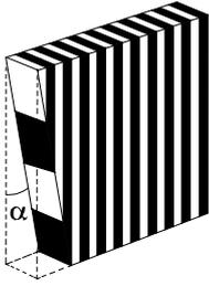
$\alpha \leq 2^\circ$ 连接器导电层或绝缘层偏离于垂直工作面的角度, 可由端面黑白色数判断。SQL (色数) $\leq (2 \times H \times \text{tg}\alpha / \text{P 值}) + 1$ ( $\text{tg}2^\circ = 0.035$ ) |                                                        |                           |                  |
